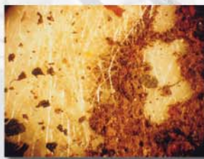
Отфильтрованные частицы ржавчины
