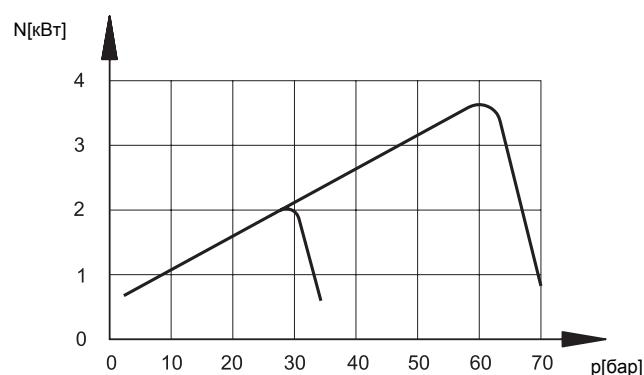
**9- ДИАГРАММЫ ХАРАКТЕРИСТИК PVE023** (полученные с использованием минерального масла при вязкости 46 сСт и температуре 40°C)
