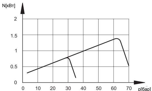
**7- ДИАГРАММЫ ХАРАКТЕРИСТИК PVE011** (полученные с использованием минерального масла при вязкости 46 сСт и температуре 40°C)
