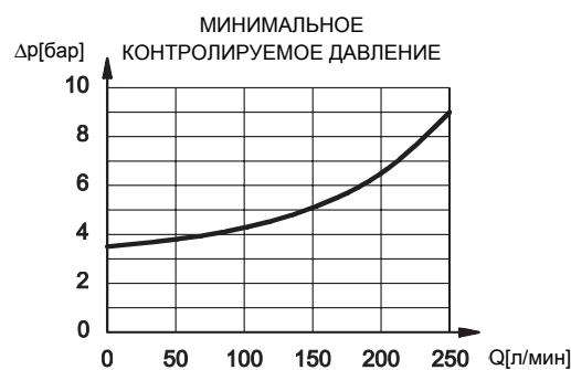
**ПРИМЕЧАНИЕ:** Максимальный расход 150 л/мин соответствует максимальному номинальному расходу в отверстии Р 1/2" BSP (через монтажную поверхность для соединительных плит P2D и P4D).
